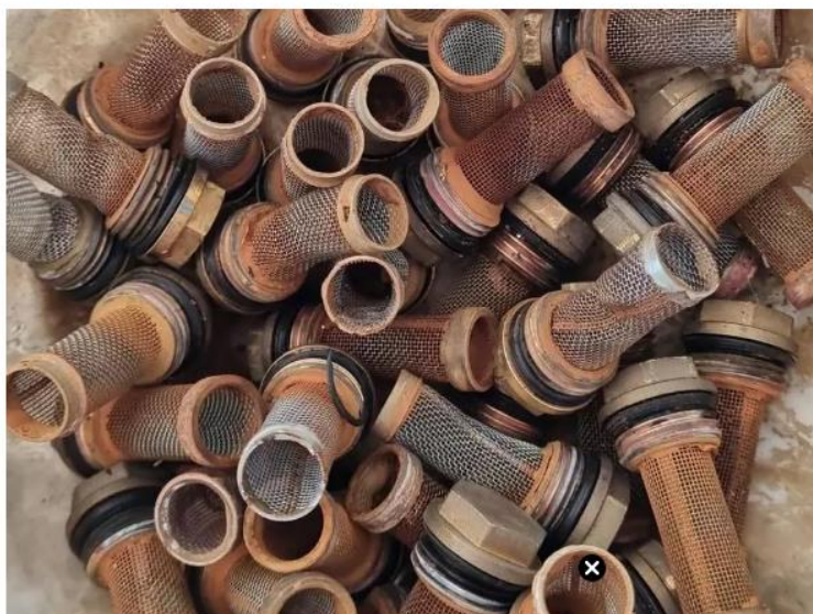
Cambio de piezas enfangadas en la subestación de biomasa del bloque de pisos de protección oficial de la Marina del Prat Vermell / CEDIDA
